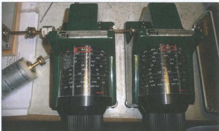
Fig. 7: Measuring setup for single MA4E1318 diode on 76 GHz. Foto 7: Messeinstellung bei eingebauter Diode MA4E1318 bei 76 GHz.
