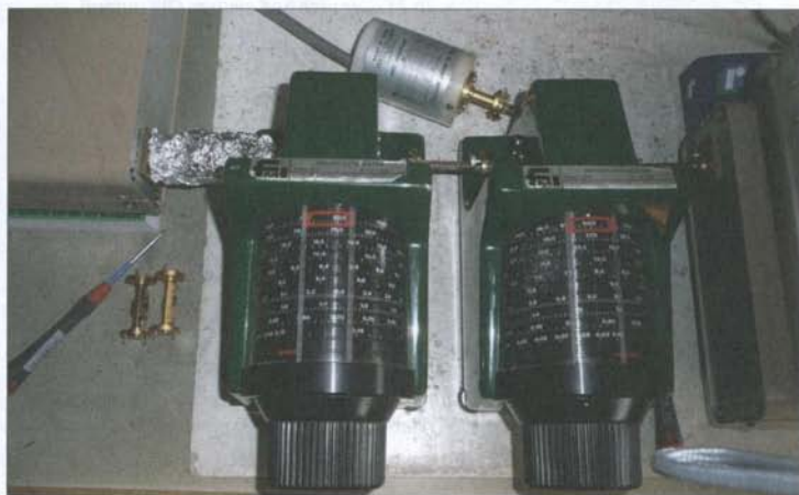
Fig. 6: A leaky isolator and flange on 76 GHz. Foto 6: Undichter Isolator bzw. Flansch auf 76 GHz.
